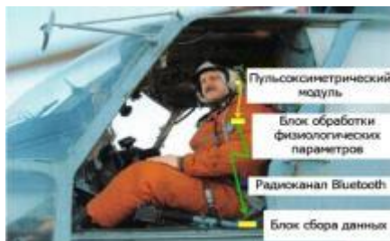
Рис. 1. Пример размещения устройства контроля функционального состояния на теле пилота вертолѐта
