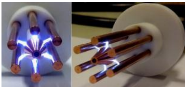
Рис. 2. Разряд между анодами и катодом в действующей модели магнитоплазодинамического двигателя
