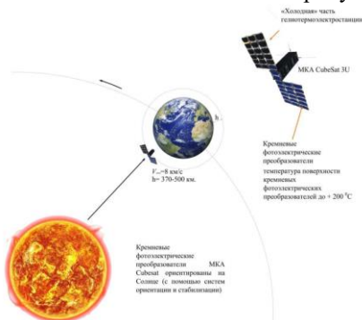
Рисунок 1 – Общая схема работы МКА с ГТЭС
