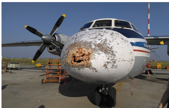
Рис. 1. Разрушение носа обтекателя локатора самолета Ан-24РВ
