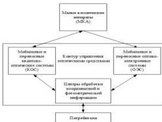
Рис.2. Схема информационной оптической системы, работающей с сетью малогабаритных переносных КОС и ОЭС.
