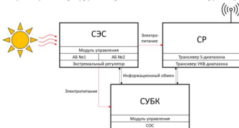
Рис. 2 – Структурная схема МКА «Хорс»
