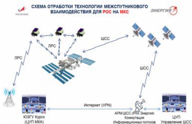
Рис. 3. Схема обработки технологии межспутникового взаимодействия для РОС на МКС
