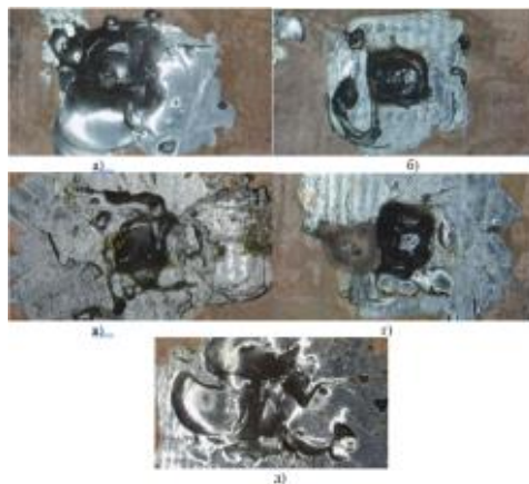
Рис.1. Образцы расплавленного припоя: а) индий, б) Sn90Pb10, в) Sn99Cu1, г) KAINA, д) Sn63Pb33.
